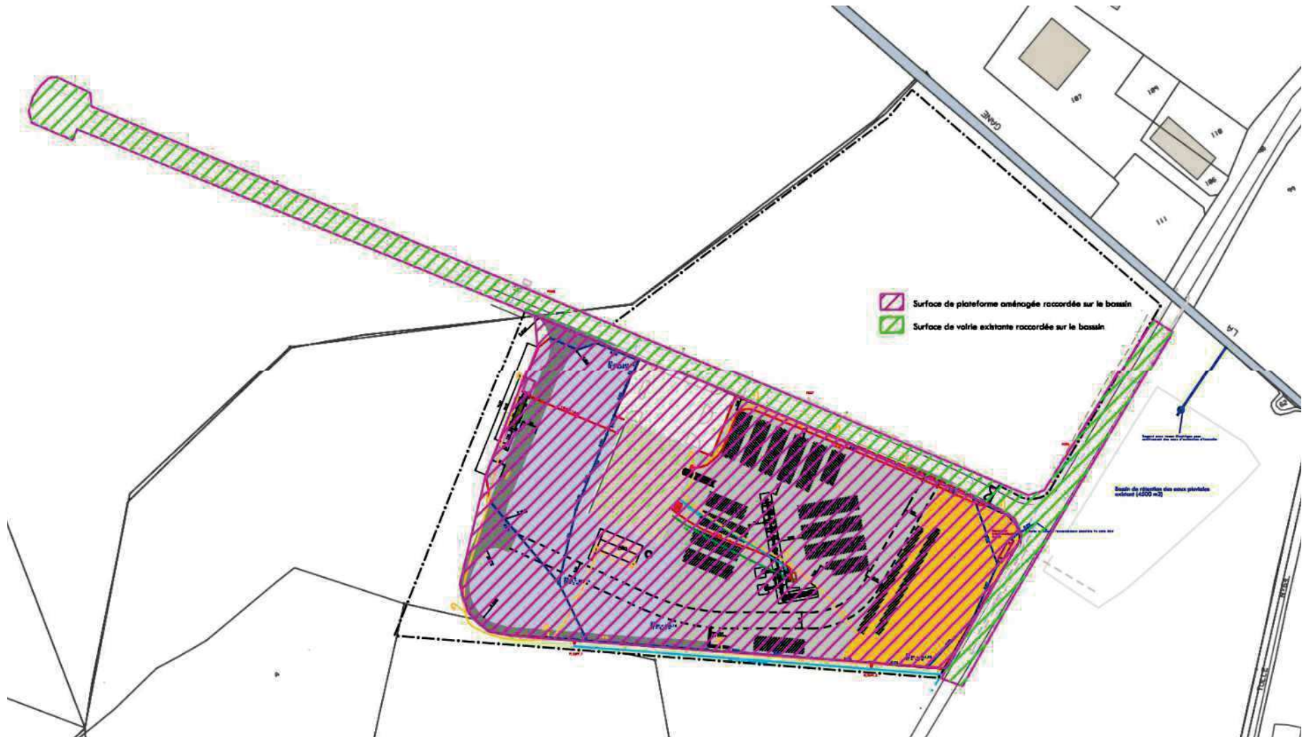
Figure 14 – Détermination des surfaces imperméables raccordées au bassin de rétention des eaux pluviales de la zone d'activités
