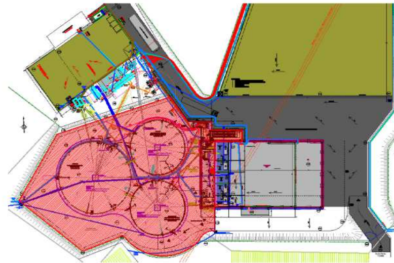
Localisation en rouge de la zone de rétention autour des cuves (source : Sud-Ouest Biogaz)
