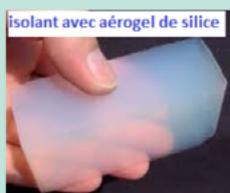
Une autre solution consiste à avoir entre les enveloppes de l'isolant, de l'air ou un gaz inerte, c'est-à-dire totalement immobile empêchant là aussi la transmission de chaleur. Cela est possible grâce aux matériaux nanostructurés comme les aérogels.
