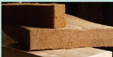
Les isolants en fibre de bois correspondent à des produits assemblés par adhésion à partir de fibres de bois et constitués d'au moins 80 % en masse de fibre de bois. Ils sont généralement fabriqués par voie sèche, c'est-à-dire sans eau, et sont soumis à la norme NF EN 13171.
