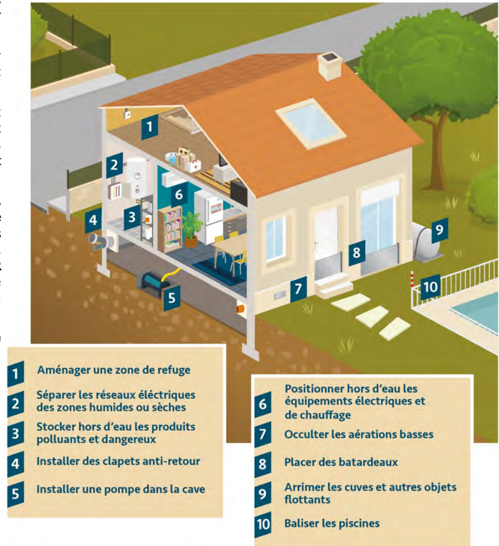
Figure 6 : Exemple de maison résiliente au risque inondation (Mayane, 2022)
