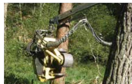
Flexible d'alimentation d'une tête d'abatteuse
