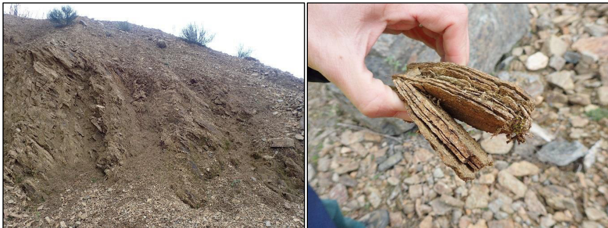
Figure 9 : Frange d'altération en partie Sud de la carrière (à g.) et échantillon altéré se délitant suivant son plan de schistosité (à d.) - Source : AG, rapport A93437A
