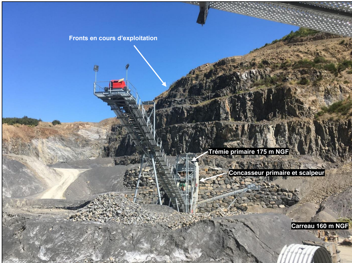
Photo 3 : Vue sur le primaire et les fronts de la carrière actuelle depuis le carreau
