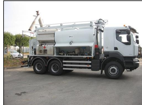
Photo 1 : Exemple d'UMFE pouvant être utilisée sur la carrière pour les opérations de minage
