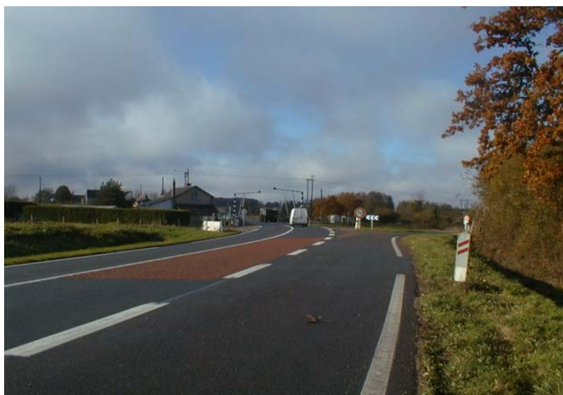
Illustration 11 : exemple de revêtement haute adhérence (en rouge)
